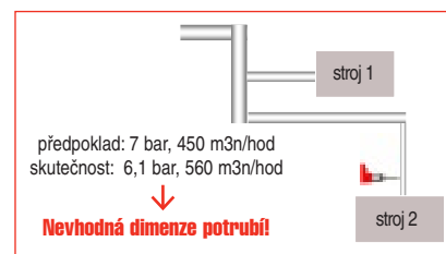
Obr. 3: Kontrola distribuční soustavy
